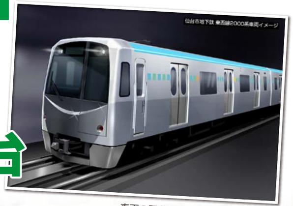
車両の駆動にはリニアモーター方式を採用。トンネル断面積が小さいため建設費コストを抑えられるなどさまざまなメリットがあります。
