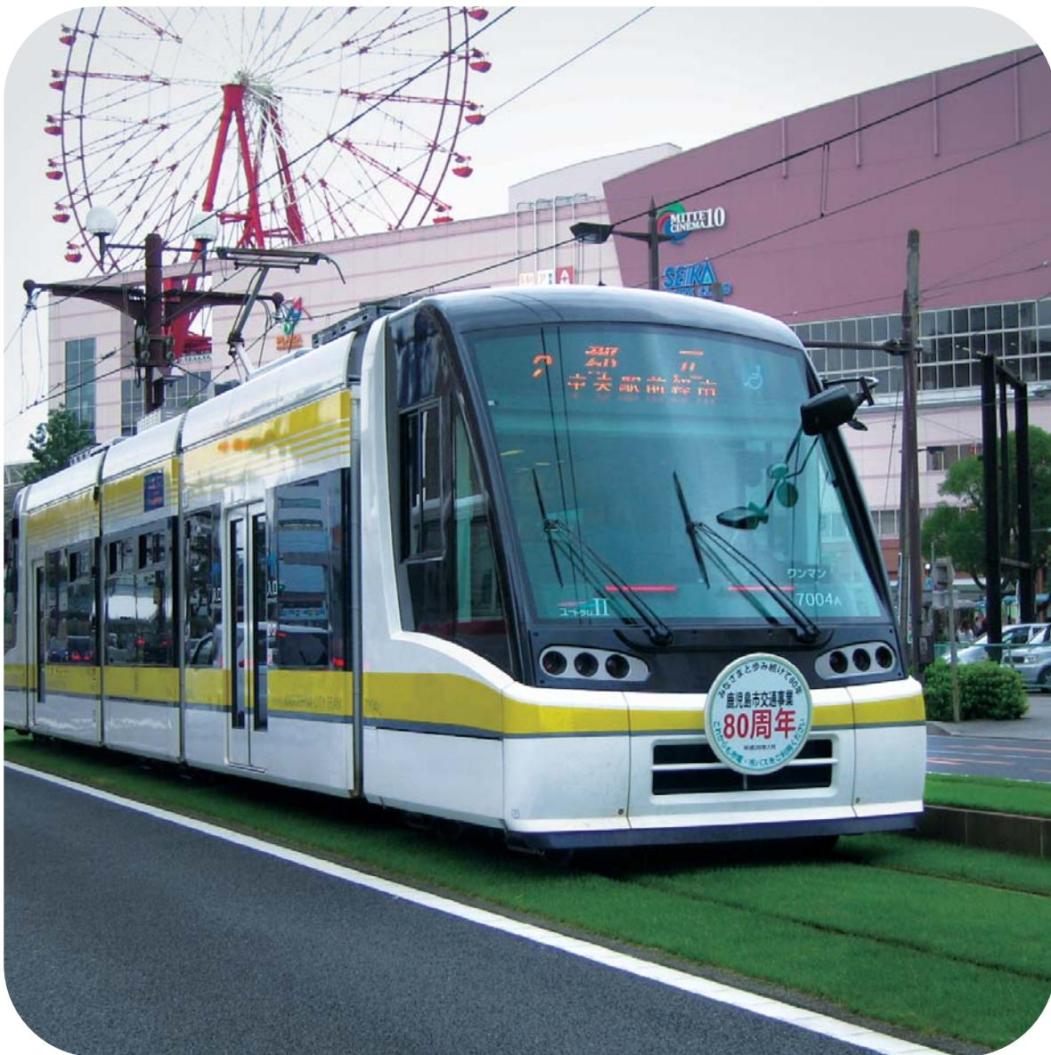
写真：鹿児島市電 連接式超低床電車（ユートラムII）
