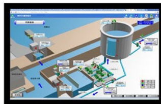
設備監視システム
